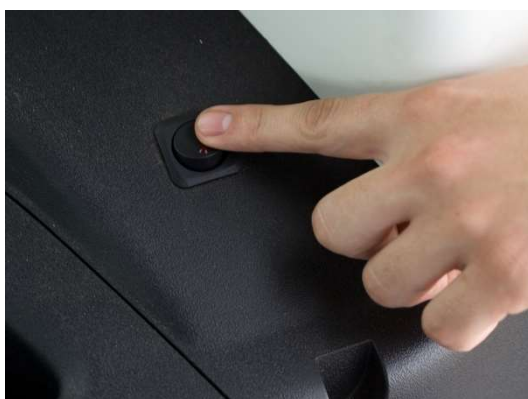
Obrázek 4 Přepněte vypínač aretace pásu (kontrolka zhasne). Tím se opět zapnula bezpečnostní funkce pásů. (Během jízdy a při parkování nesmí kontrolka svítit)
