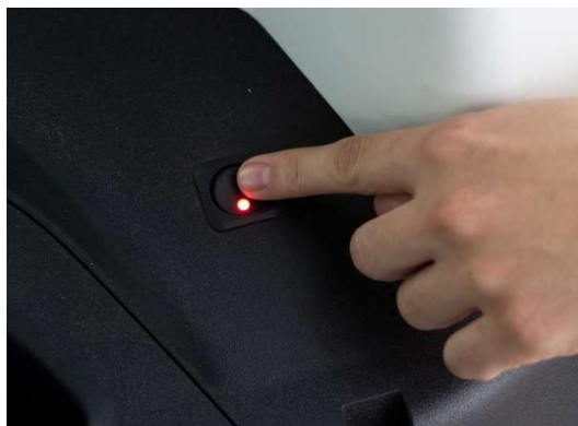
Obrázek 2 Pásy jsou jištěny aretací. Před jejich vytažením zapněte vypínač aretace umístěný na pravé straně vozidla. Rozsvítí se červená kontrolka - pásy jsou uvolněny.
