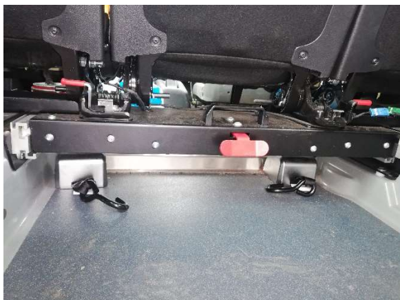
Obrázek 3 a 4 Znáznorňuje způsob sklopení a zajištění sedadel.
