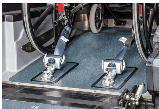
Obrázek 6 upevněný pás vytáhněte a zahákněte za pevnou část rámu vozíku. Utažení pásu se provádí pomocí šroubu označeném na obr.12 – utáhněte pevně.
