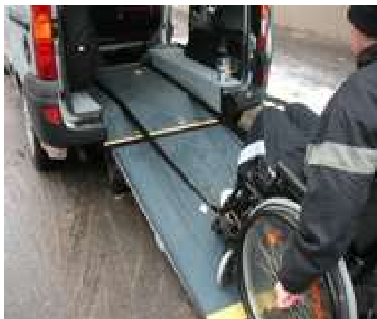
Obrázek 3 Vytáhněte pásy ven z vozidla a upevněte je za rám v přední části invalidního vozíku. Nikdy nepřipevňujte pásy za stupačky invalidního vozíku.
