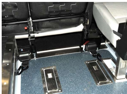
Obrázek 1 Pod sklopenou sedačkou jsou umístěny dva samonavíjecí pásy. Než najedete do vozu, vytáhnete tyto pásy ven a uchytíte je za pevnou část rámu invalidního vozíku.
