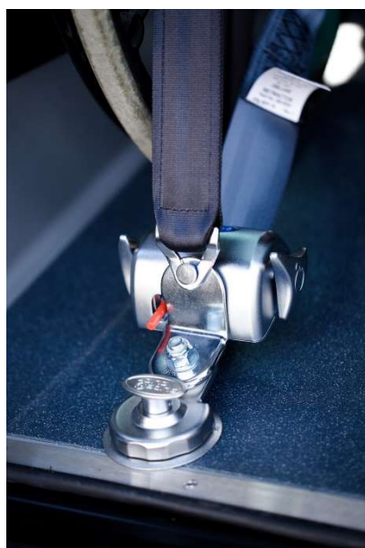
Obrázek 8 Detail upevnění břišního pásu
