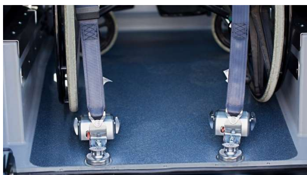
Obrázek 8 Detail upevnění břišního pásu
