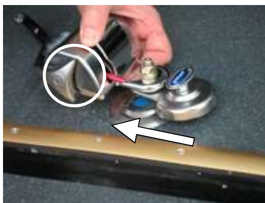
Obrázek 5 Upevněte zadní samonavíjecí pásy do úchytu na podlaze vozu ve směru šipky
