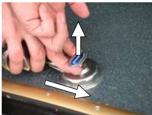
Obrázek 7 Demontáž se provádí povytažením aretace a vysunutím z úchyty v podlaze vozu.
