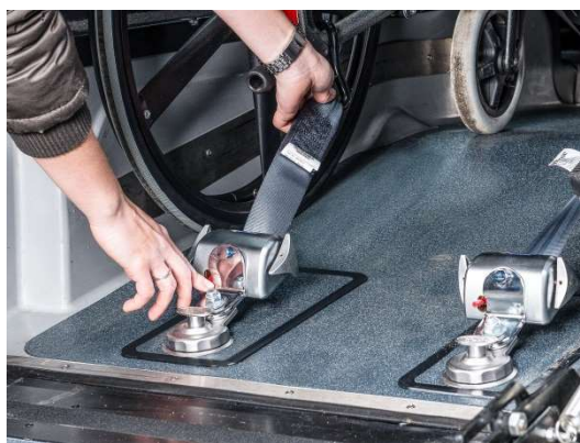
Obrázek 2 Pro odepnutí pásu z vozíku je nutné uvolnit červenou pojistku aretace.
