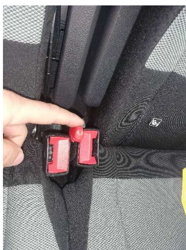
Obrázek 3 a 4 Znáznorňuje způsob sklopení a zajištění sedadel.
