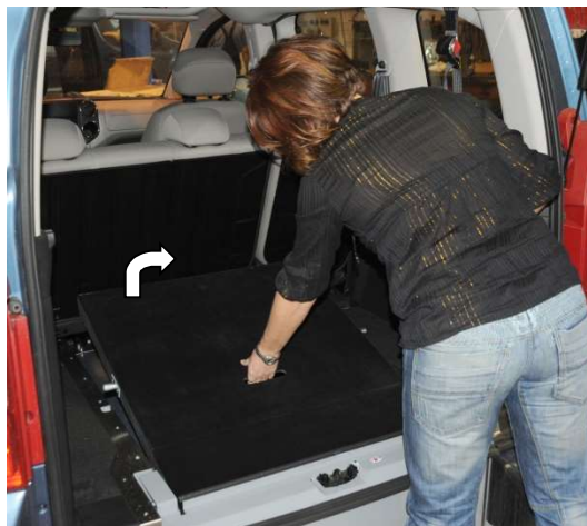
Obrázek 1 Zatáhněte za rampu umístěnou na podlaze, až ji dostanete do svislé polohy
