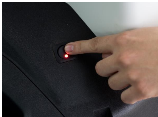
Obrázek 7 Pásy jsou jištěny aretací. Před jejich vytažením zapněte vypínač aretace umístěný na pravé straně vozidla. Rozsvítí se červená kontrolka - pásy jsou uvolněny.
