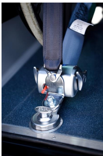
Obrázek 15 Detail upevnění břišního pásu
