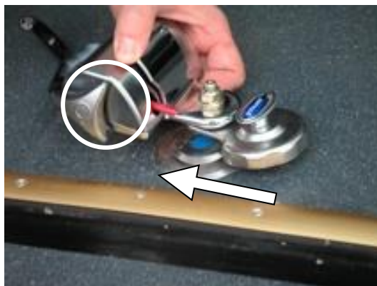
Obrázek 11 Upevněte zadní samonavíjecí pásy do úchytu na podlaze vozu ve směru šipky
