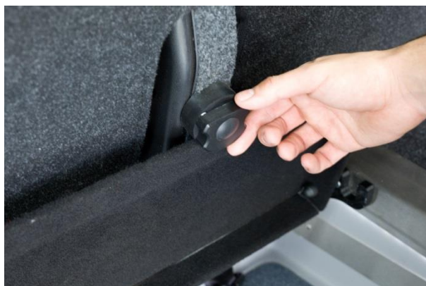
Obrázek 6 Tento kryt zvedněte a uchytěte ho k sedačce otočením držáku
