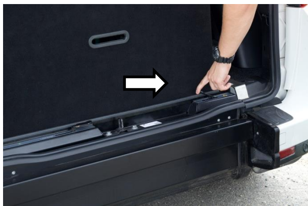
Obrázek 2 Zatlačte na páčku Open doprava a rampu vyklopte z vozidla.
