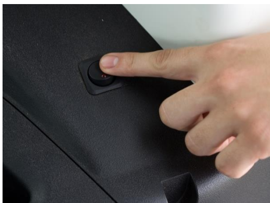
Obrázek 10 Přepněte vypínač aretace pásu (kontrolka zhasne). Tím se opět zapnula bezpečnost funkce pásů. (Během jízdy a při parkování nesmí kontrolka svítit)
