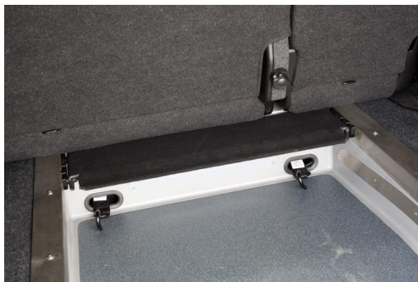
Obrázek 5 Uvnitř prostoru vozu je kryt, který slouží k zakrytí zavazadlového prostoru, pokud se nepřeváží vozíčkář
