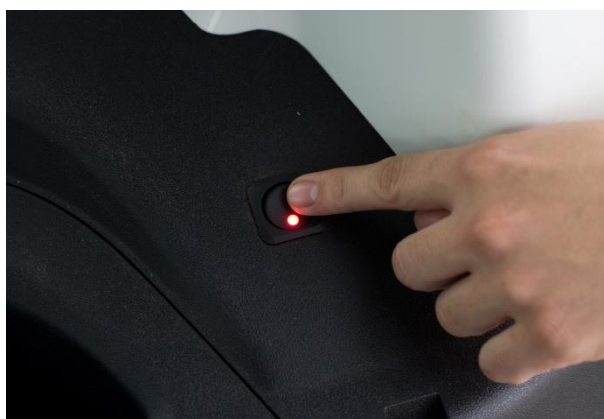
Obrázek 18 Při vyjíždění s vozíkem ven z vozidla přepnete vypínač aretace pásu (kontrolka svítí). Tím jsou přední samonavíjecí pásy uvolněny a umožňují vyjet s vozíkem ven z vozidla
