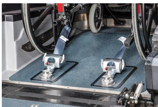
Obrázek 12 upevněný pás vytáhněte a zahákněte za pevnou část rámu vozíku. Utažení pásu se provádí pomocí šroubu označeném na obr.12 – utáhněte pevně.
