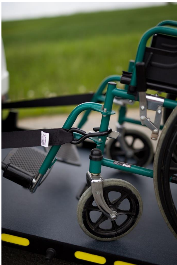
Obrázek 9 Vytáhněte pásy ven z vozidla a upevněte je za rám v přední části invalidního vozíku. Nikdy nepřipevňujte pásy za stupačky invalidního vozíku.
