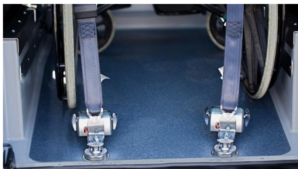
Obrázek 16 Detail upevnění břišního a ramenního pásu
