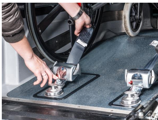
Obrázek 13 Pro odepnutí pásu z vozíku je nutné uvolnit červenou pojistku aretace.
