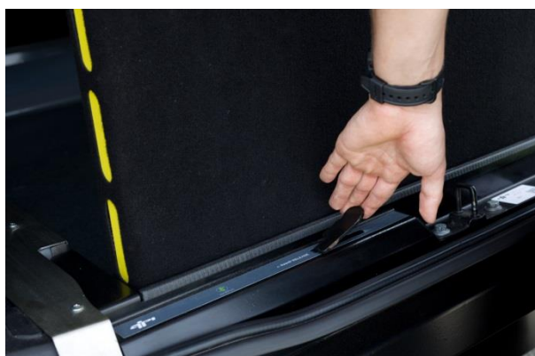
Obrázek 19 Pro složení rampy zpět na podlahu vozu rampu nejdříve posuňte páčku doleva
