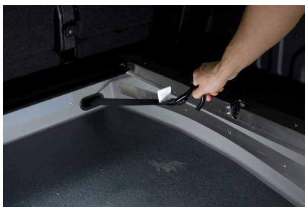
Obrázek 8 Za sedačkami jsou umístěny dva samonavíjecí pásy. Než najedete do vozu, vytáhnete tyto pásy ven a uchytíte je za pevnou část rámu invalidního vozíku.
