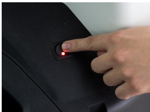
Obrázek 9 Pásy jsou jištěny aretací. Před jejich vytažením zapněte vypínač aretace umístěný na pravé straně vozidla. Rozsvítí se červená kontrolka - pásy jsou uvolněny.
