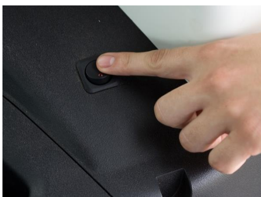
Obrázek 11 Přepněte vypínač aretace pásu (kontrolka zhasne). Tím se opět zapnula bezpečností funkce pásů. (Během jízdy a při parkování nesmí kontrolka svítit)
