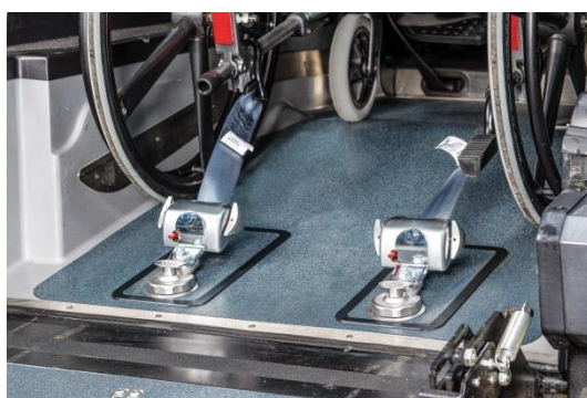
Obrázek 13 upevněný pás vytáhněte a zahákněte za pevnou část rámu vozíku. Utažení pásu se provádí pomocí šroubu označeném na obr.12 – utáhněte pevně.
