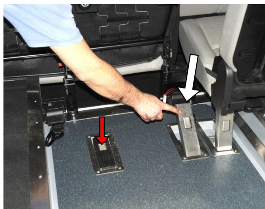
Obrázek 7 Sedačku překlopte za přední sedadla vozu a kotevní úchyty sklopte k podlaze. Tím se připravilo místo pro invalidní vozík. Kotevní úchyty vyklopíte zpět zmáčknutím prostřední části úchytu (PRESS).
