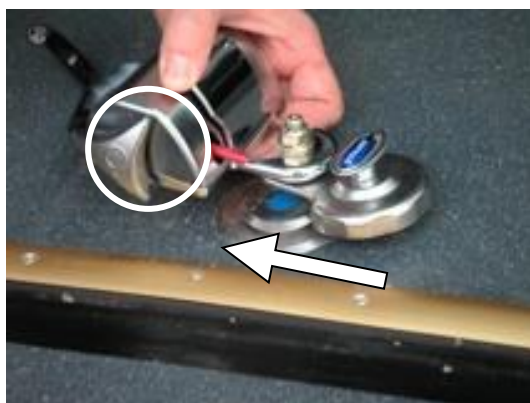
Obrázek 12 Upevněte zadní samonavíjecí pásy do úchytu na podlaze vozu ve směru šipky
