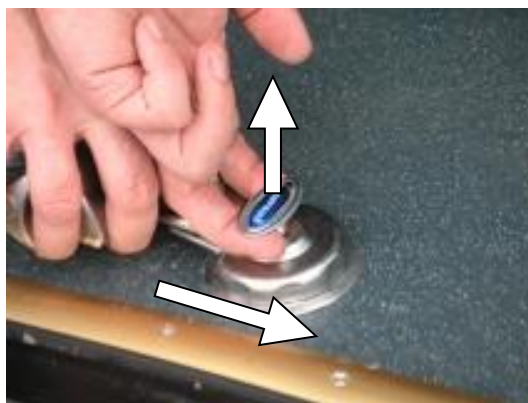
Obrázek 15 Demontáž se provádí povytažením aretace a vysunutím z úchyty v podlaze vozu.
