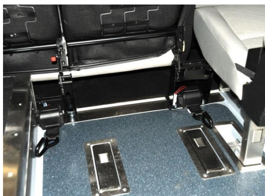
Obrázek 8 Pod sklopenou sedačkou jsou umístěny dva samonavíjecí pásy. Než najedete do vozu, vytáhnete tyto pásy ven a uchytíte je za pevnou část rámu invalidního vozíku.
