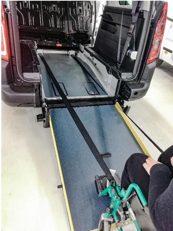
Positionieren Sie den Rollstuhl so, dass die Gurte der Retraktoren grade eingezogen werden können. Für Beschädigungen aus Nichtbeachtung kann keine Garantie übernommen werden.
