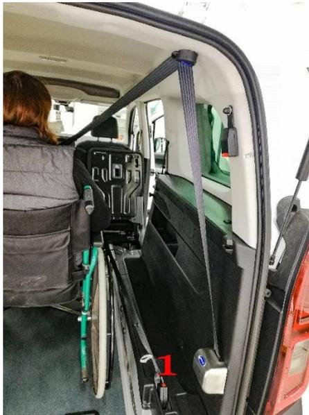
Achten Sie darauf, dass das hier beschriebene 3-Punkt Gurtsystem ausschließlich zur Sicherung von im verladenen Rollstuhl sitzenden Personen verwendet wird. Die Gurte sind eng an der Person anliegend zu verwenden, dürfen während der Fahrt keinesfalls gelöst werden und es sind alle Sicherheitsvorschriften des Fahrzeugherstellers zu beachten.
